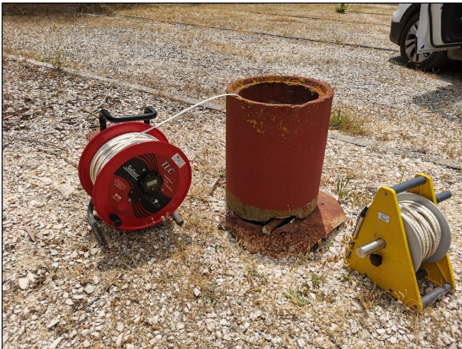
Μετρήσεις στάθμης και Logging Ηλεκτρικής αγωγιμότητας και θερμοκρασίας στη γεώτρηση ΑΓ29 απέναντι από τον αρχαιολογικό χώρο.
