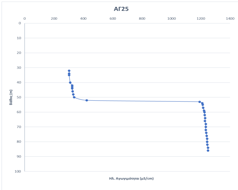
Εικόνα 8. Logging Αγωγιμότητας με το βάθος στη γεώτρηση TE_1ΑΓ25
