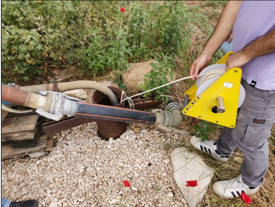
Μετρήσεις στάθμης σε γεώτρηση με σταθμήμετρο της ΟΤΤ.
